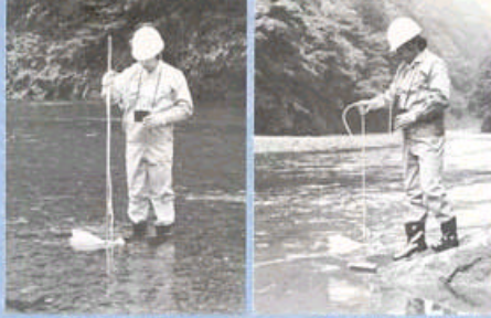
●測定ロッドを使用しての測定
